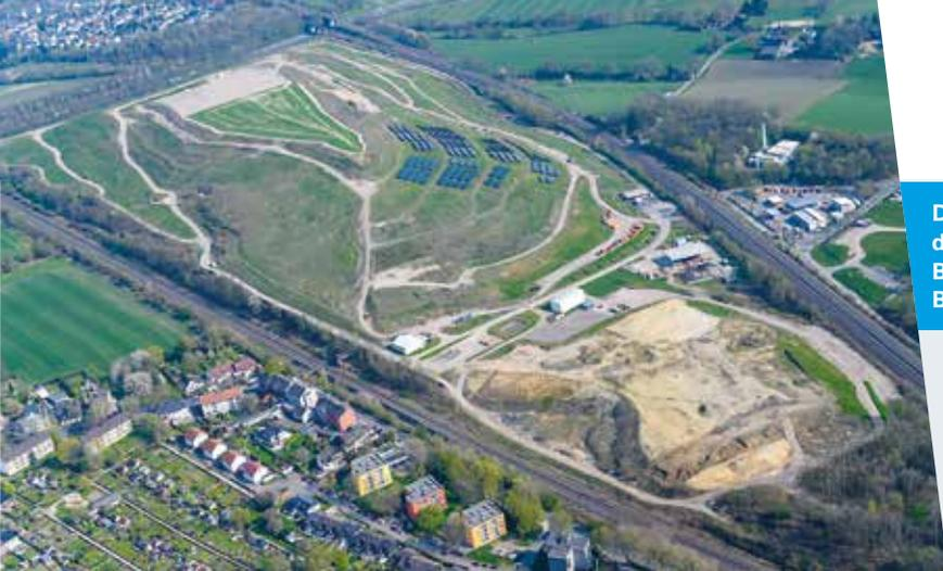
Die Zentraldeponie Kornharpen von oben. Im Vordergrund ist das Bodenzwischenlager zu sehen. Der erste und der zweite Bauabschnitt befinden sich im hinteren Bereich der Deponie. Bild: USB (Lutz Leitmann)
